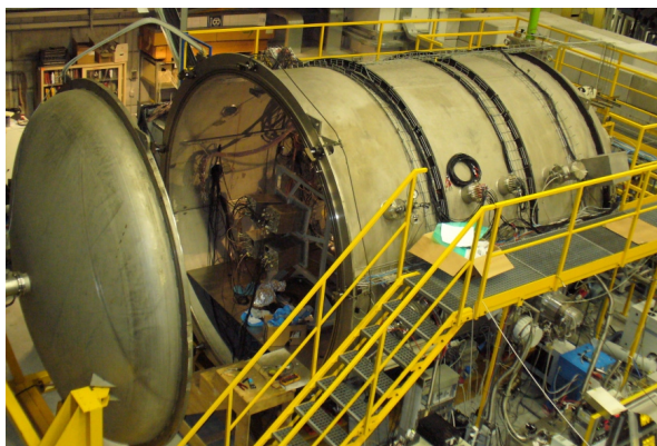
Rysunek 2.2: Próżniowa komora rozproszeń układu GARFIELD (cylinder o średnicy \sim 3 m, długości \sim 5 m), wewnątrz której umieszczono wszystkie detektory układu pomiarowego.
